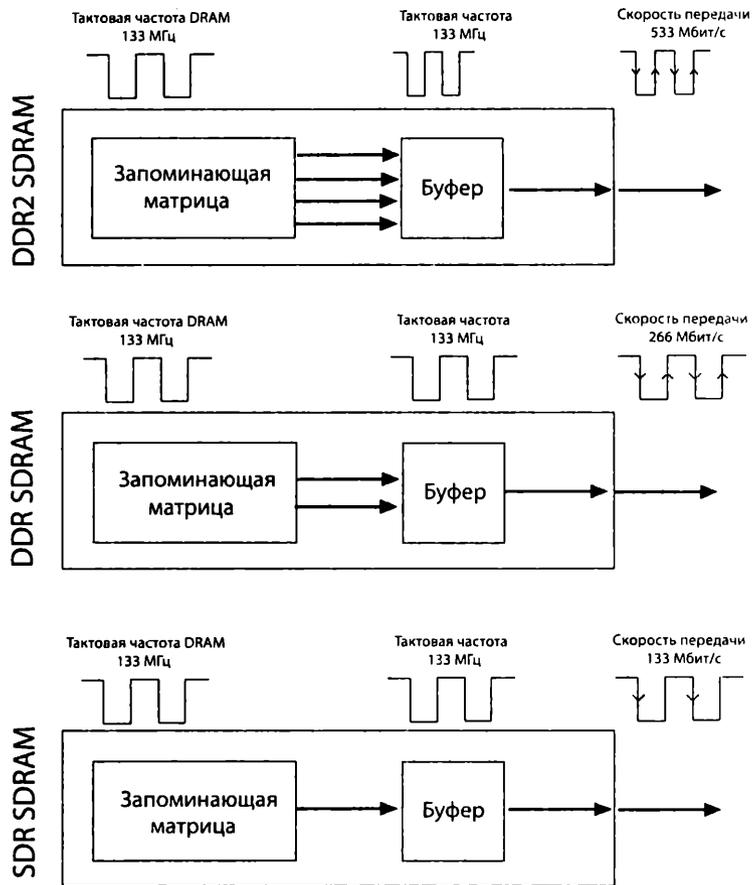
**Рис. 5.5.** Принцип функционирования памяти SDRAM, DDR и DDR2
