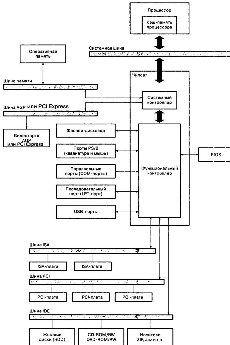
**Рис. 1.3. Функциональная схема взаимодействия устройств компьютера**
