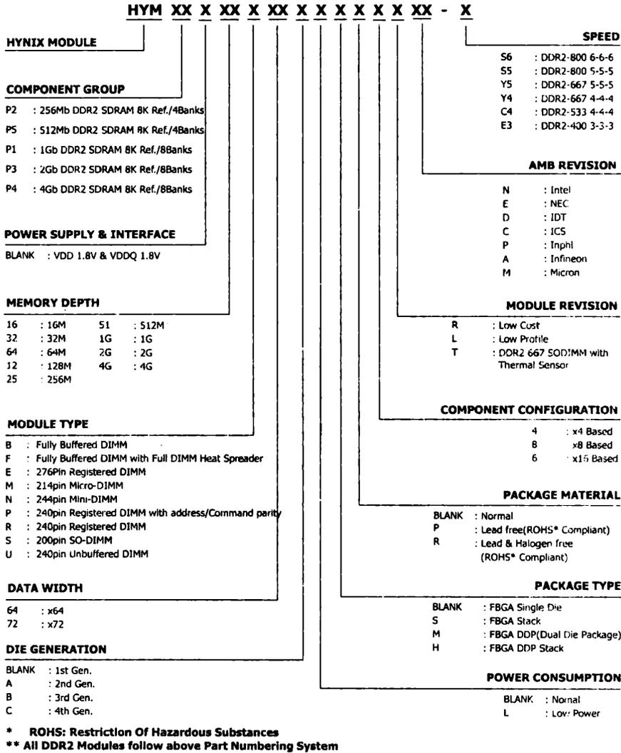
**Рис. 5.4. Маркировка модулей DDR2 производства HYNIX**
