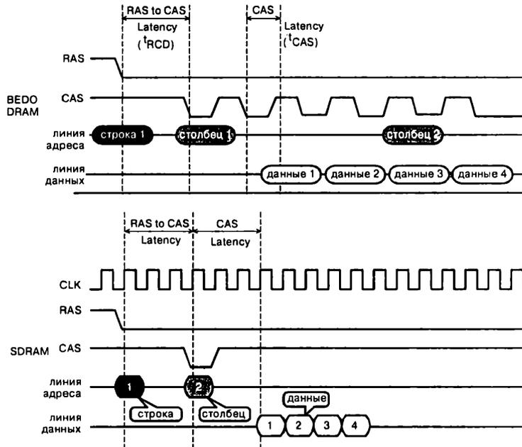
**Рис. 5.2. Диаграмма работы модуля BEDO DRAM и модуля SDRAM**
